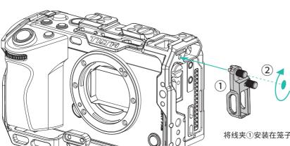
将线夹①安装在笼子右侧臂上方的M3螺纹孔上,拧紧螺丝②完成装配。
